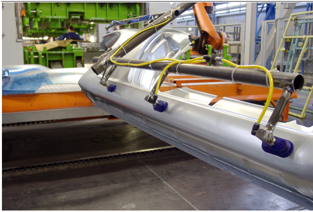
Ventosas de fuelle SAOB durante la manipulación de piezas de carrocería
